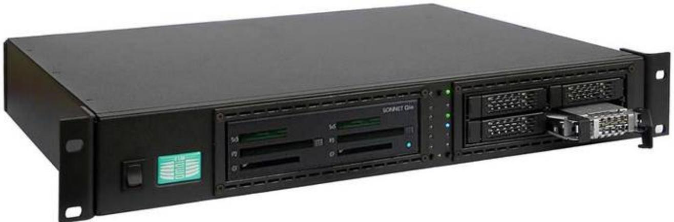
Das Omni Rack-Basisgehäuse mit Sonnet QIO MR Kartenleser und 4 x 2,5-Zoll-HDD RAID 5 System. In dieser Konfiguration eignet sich das System auch für die mobile Videoproduktion.
